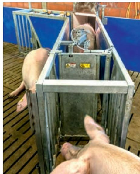
Portillon d'entrée à un battant et à ouverture électropneumatique
